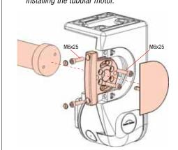
6b Instalación de máquina por interior.
