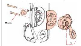
Nota: Máquina Ciclon pasante con tornillos M6x60 y con tuercas, Máquina G8 con tornillos M6x60.
