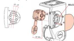
Nota: Máquina Ciclon pasante con tornillos M6x50 y con tuercas, Máquina G8 con tornillos M6x40,
