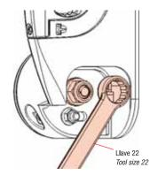
Si procede, colocar la redonda de regulación en la posición más próxima a la inclinacion deseada.
