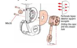
Nota: Máquina Ciclon pasante con tornillos M6x50 y con tuercas, Máquina G8 con tornillos M6x40,
