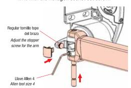
Ajuste y bloqueo. / Tighten and block.
